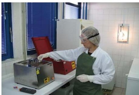
**Slika 6.14.** Određivanje količine masti acido butiometrijskom metodom po Gerberu
