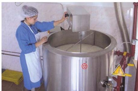
**Slika 11.33.** Sirarski kotao u radnom pogonu (izvor: S. Kalit)
