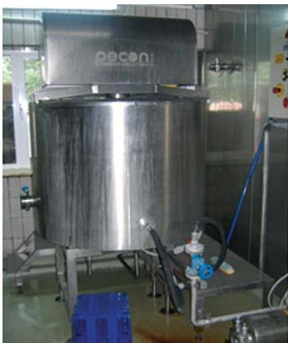
**Slika 2.3.** Sirarski kotao u kojem se provodi niska pasterizacija (fotografija: S. Kalit)
