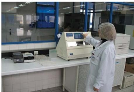
**Slika 6.12.** Određivanje točke smrzavanja
