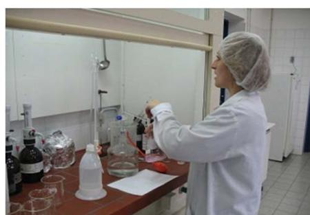
**Slika 6.17.** Određivanje titracijske kiselosti po Soxhlet-Henkelu
