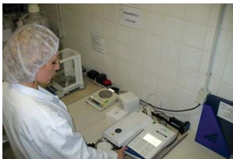
**Slika 6.18.** Određivanje ukupne suhe tvari
