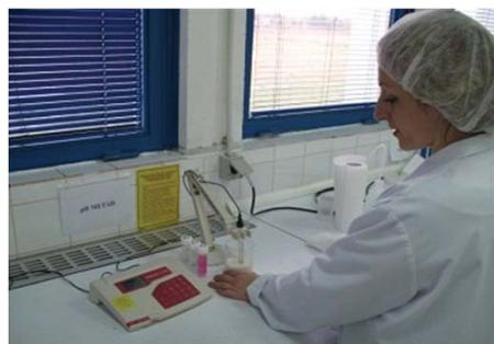
**Slika 6.15.** Utvrđivanje pH vrijednosti mlijeka ionometrijskom metodom
