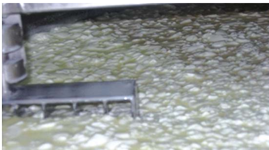
Slika 2.8: Rezanje koaguluma in omogočanje izstopanja sirotke (fotografija: S. Kalit)
