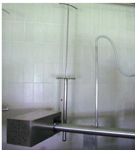
Slika 11.36: Sirarska harfa (vir: S. Kalit)
