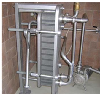
Slika 2.2: Pretočni (ploščni) hladilnik za mleko (fotografija: S. Kalit)
