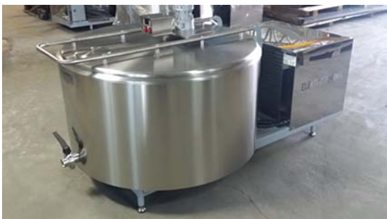
Slika 2.1: Hladilni bazen za mleko manjše zmogljivosti (fotografija: S. Kalit)
