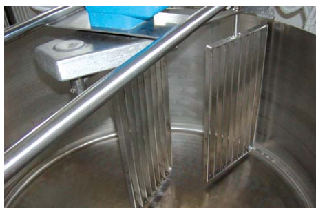
Slika 11.34: Notranjost kotla s sirarsko harfo (vir: V. Magdič)
