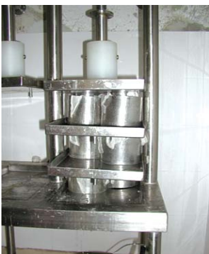
Slika 11.39: Preša na vi- jak (vir: S. Kalit)
