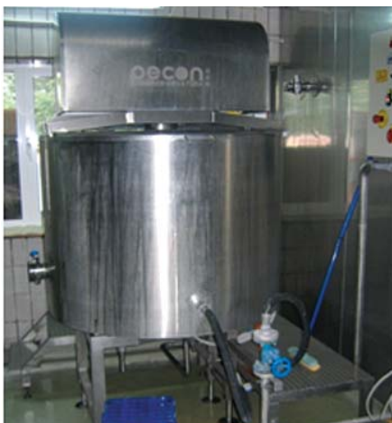
Slika 2.3: Sirarski kotel, v katerem poteka nizka pasterizacija (fotografija: S. Kalit)
