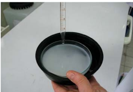
Slika 6.16: Ugotavljanje kislosti (svežosti) mleka z alkoholnim testom
