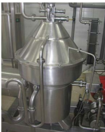
Slika 2.4: Posnemalnik za posnemanje in tipizacijo mleka (fotografija: S. Kalit)
