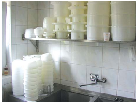
Slika 11.43: Trodelni kalupi za prešo (vir: V. Magdić)
