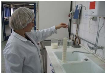
Slika 6.13: Določitev gostote mleka z laktodenzimetrom
